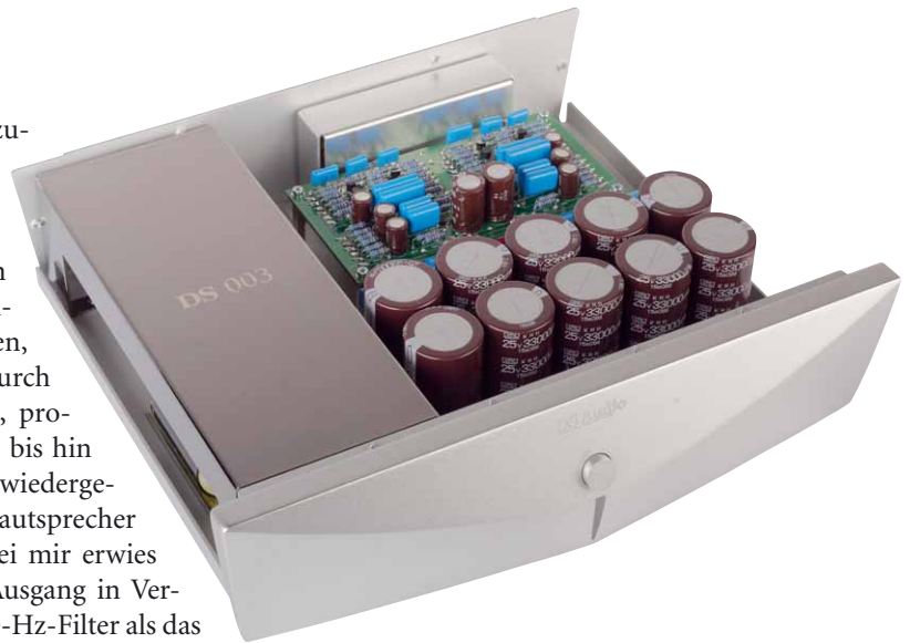
Unter dem Abdeckblech steckt der Netztrafo, der Materialeinsatz ist beachtlich
