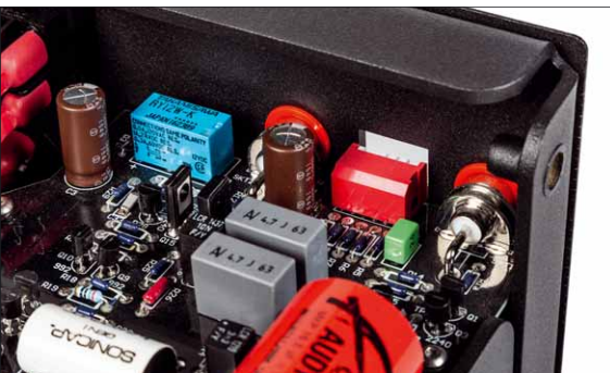
Direkt an den DIP-Schaltern sind die entsprechenden Widerstände auf die Platine gelötet - auf Wunsch können andere Werte eingesetzt werden
